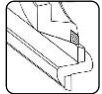
Заточка инструмента по задней поверхности
