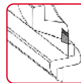
Заточка инструмента по задней поверхности
