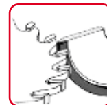
Заточка инструмента по задней поверхности
