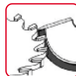
Заточка фрез по передней поверхности
