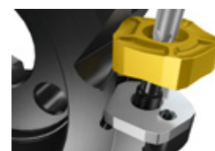
6. Поднимите ее над головкой винта, поверните или извлеките. Повторите шаги 2 и 3.
