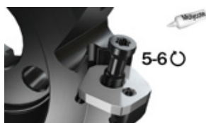
1. Нанесите смазку Molycote на резьбу и закрепите винт на 5-6 оборотов.
