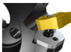
2. Поместите пластину в гнездо под углом и установите ее на опорную пластину.
