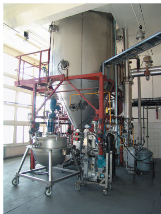
Установка распылительной сушки и грануляции твердосплавных смесей
