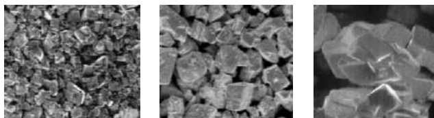
Микроструктура порошков вольфрама (1), триоксида вольфрама (2), паравольфрамата аммония (3), полученная на электронном микроскопе фирмы "Tesla"
