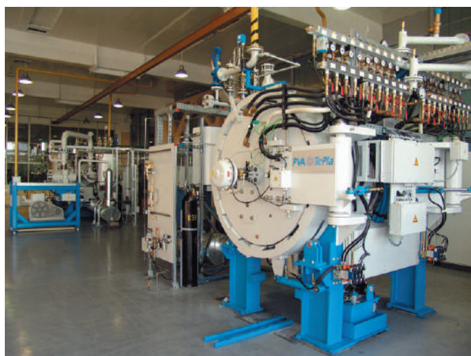
Вакуумно-компрессионная печь спекания фирмы "PVA TePla"
