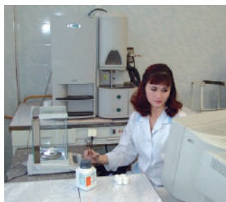
Для точного определения содержания углерода, кислорода, азота, серы используется оборудование фирмы "LECO"
